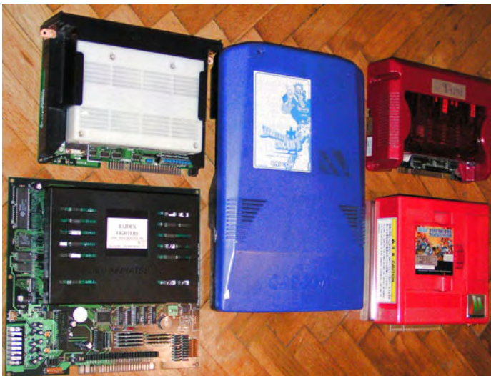
Kleine Auswahl an Systemplatinen: links oben: SNK MVS mit Cart (Pulstar), links unten: Seibu Kaihatsu SPI System mit Raiden Fighters Cart, Mitte: blaues CPS II b-Board / US-Version von Battle Circuit, rechts oben: PGM-Motherboard mit Gladiator-Cart, rechts unten: Atomiswave-Motherboard mit Fist of the Northstar (Hokuto No Ken).
